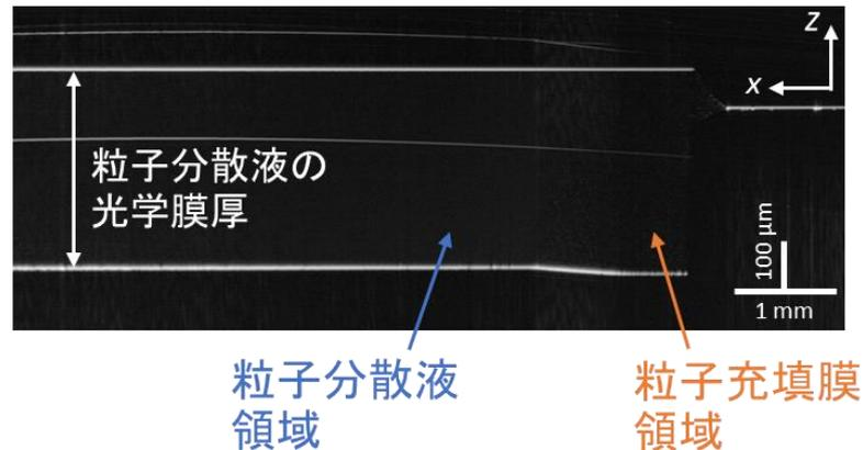
図 1 (上図)実験の概略図。赤色点線部分をスキャンして、蒸発端面近傍での分散液内の粒子濃度分布を計測した。(下図)OCT で得られた、乾燥中の粒子分散液内の断面画像。この画像を解析することで粒子濃度分布を定量化できる。図は *Soft Matter*, 2024, 20, 2381-2393 (©The Royal Society of Chemistry 2024) より改変。
